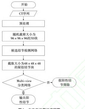
图 1 本文方法算法流程图
