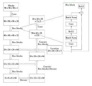
图 2 候选结节检测网络结构图
